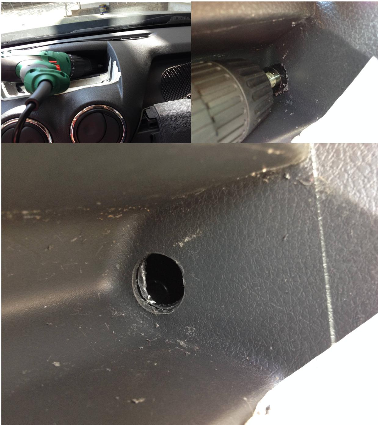
Рисунок 4 - Отверстие под кабели.
