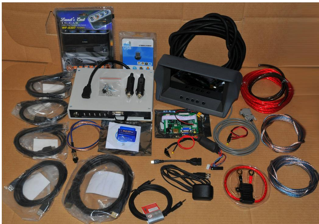
Рисунок 2 – Полный комплект android CarPC
