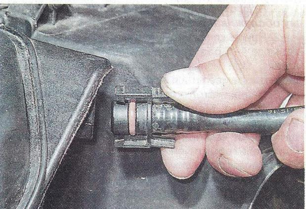
5. Вводим в отверстие клапана резиновую грушу и сжимаем ее. Если груша останется в сжатом состоянии, клапан исправен.
