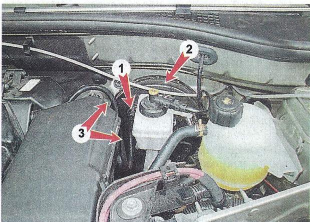
4. Проверяем работу обратного клапана **1** (при его неисправности разрежение в вакуумной полости усилителя не сохраняется). Для этого, выключив двигатель, извлекаем обратный клапан из корпуса вакуумного усилителя тормозов...
