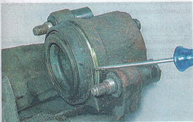
...и снимаем защитный чехол поршня.
