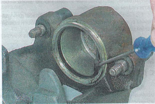
**13.** Заменяем снятые чехол и манжету, осматриваем поверхности поршня и цилиндра. При наличии следов износа, царапин или коррозии детали заменяем.
