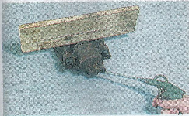
**11.** После того как давление вытолкнет поршень, извлекаем его из суппорта.
