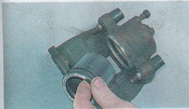
**12.** Поддев тонкой шлицевой отверткой, извлекаем манжету поршня.
