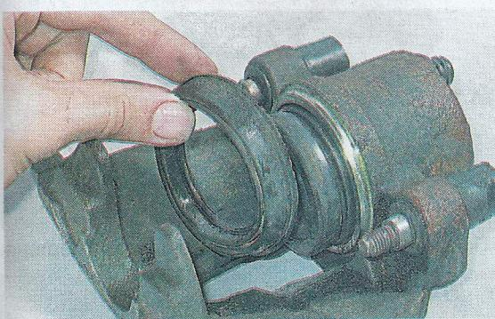
**10.** Вкладываем деревянный брускок в суппорт и подаем небольшое давление сжатого воздуха от компрессора или ножного насоса в отверстие для подвода тормозной жидкости.
