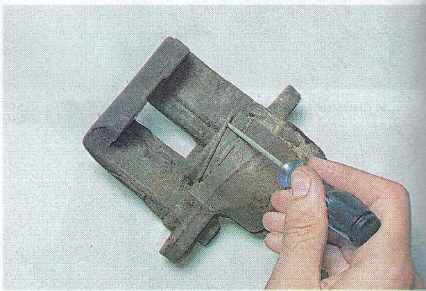
6. Поддеваем отверткой и снимаем чехол поршня.
